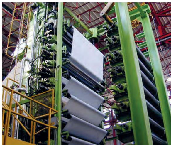
Nuova supercalandra da 18 cilindri (collezione Cartificio Ermolli).
